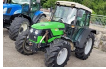
Deutz Agroplus 60 Classic (60 PS) Bj 2002 5.200 h, mech. FL, 4-Rad Bremse, Schneeketten, ...
