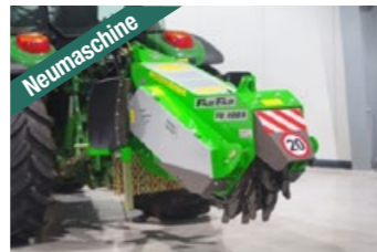
FAO FAR FV4084 (840 mm Rotor) Streifenfräse, 350 mm Arbeitstiefe, 100-250 PS, 1.450 kg, 1.000 U/min ZW, beidseitiger Riemenantrieb 10 Stk., ... Preis inkl. 20 % MWST. EUR 28.500,-
