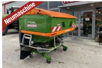
Amazone ZA-TS 2600 ProfisPro Tronic Bj 2023 2.600 l, Wiegezellenstreuer mit ISOBUS, mech. Antrieb, Zweischiebenstreuer, Grenzstreueinrichtung, ... Preis auf Anfrage
