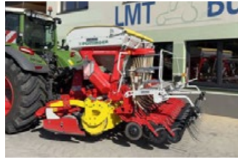
Pöttinger Fox 300D mit Aerosem 3002 ADD 300 cm Breite, DUAL DISC Doppelscheibenschare, Tiefenführungsrolle mit Abstreifer, Beleuchtung, ... Preis inkl. 20 % MWST. EUR 46.800,-
