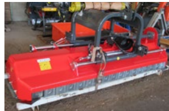
Dragone V 280 Schlegelmulcher (280 cm) 296 cm Breite, 1.000 U/min, Freilauf immer aktiv, 30 Werkzeuge, Front/Heck, hydr. Verst. 600 mm, 990 kg, ohne GW Preis inkl. 20 % MWST. EUR 10.788,-
