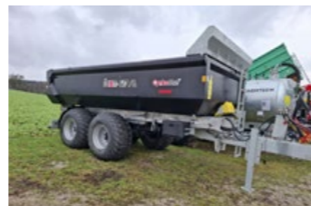
CynkoMet T-617/6 Muldenkipper (20 t) Bj 2021 11 m³, 90 cm Wände, 40 km/h, 2 t Stützlast, Deichselfed., Stützfuß/Klappe hydr., 10 mm Hardox Boden, DL-Bremse Preis inkl. MWST./Verm. EUR 27.900,-
