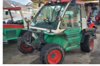
Rasant 2805 SD 4 Hydro (85 PS) Bj 2000 hydr. Fahrtrieb, 4-Rad Lenkung, 40 km/h, Klima, ...
