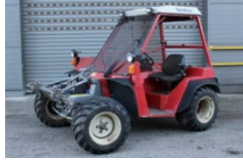
Aebi TT 80 (49 PS) Bj 1996 6.400 h, hydr. Geräteentlastung, Seitenvershub, Kubota 4-Zylinder Motor, ...
