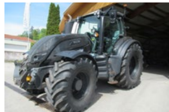
Valtra T 214 D (215 PS) Bj 2016 6.060 h, Allrad, 7,4l AGCO Power Motor 6 Zyl., gefed. Kab., Topcon GPS, FZW, ZW-Automatik, hydr. DL, 50 km/h, DW 5 Preis inkl. 20 % MWST. EUR 105.000,-
