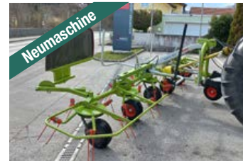
Claas Volto 60 (580 cm) Bj 2022 Dreipunkt-Kreiselleuer, hydr. Hochst., 6 Kreisel je 5 Zinken, Grenzstreueinr., PERMALINK Antriebskonzept, ... Preis auf Anfrage
