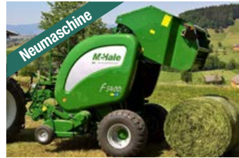
McHale F 5400C Bj 2023 Festkammer, 18 Presswalzen aus Feinkornstahl, 15 Messer Schneidwerk, RNH, Netz., 540 mm Hochleistungsrotor Preis inkl. 20 % MWST. EUR 46.500,-
