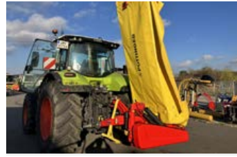
Pöttinger Novadisc 352 (346 cm) Bj 2022 20 h, neuwertig, Heck-Scheibenmäherwerk, hydr. Rückschwenkung, GW, 1000 U/min, Verschleißkufen, Hochstell. Preis inkl. MWST./Verm. EUR 13.500,-
