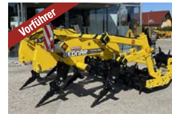
Bednar Terraland TN3000 MSR (300 cm) Bj 2023 20 h, Tiefenlockerer, 5 ActiveMix Zinken, Doppelstachelwalzen, hydr. Breitenverst., klappb. Walzenverbreiterung Preis inkl. 20 % MWST. EUR 17.900,-
