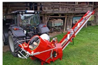
AMR Vogesenblitz Quatromat Trommelsäge 250 - 520 mm Schnittlänge, starrs od. schwenkbares Förderband, ZW-Antrieb (optional mit E-Motor kombinierbar) Preis inkl. 20 % MWST. ab EUR 15.400,-
