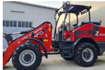
Schäffer Hoftrac 5680Z (75 PS) Bj 2021 10 h, 30 km/h, LED, Luftsitz, hydr. Verriegelung, Multikuppler, 2.800 kg Hubkraft, 340 cm Hubhöhe, Weidemann Aufn., ... Preis inkl. 20 % MWSt. EUR 65.990,-
