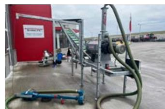
Fliegl Tapir 375 Gülleseparator, Stapleraufnahme, Schaltschrank, Überlauf und Rücklaufschlauch, höhenverst. Füße, 21 A Stromvers. Preis auf Anfrage
