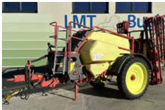
Kverneland Spridtrain GV1 (3.800 l - 21 m) Bj 2004 7 Teilbreiten, Müller Terminal, Section Control mit ISOBUS, 3-fach Düsenkopf, hydr. Klapp., Hangsteuerung, WW-GW Preis inkl. 20 % MWST. EUR 19.500,-
