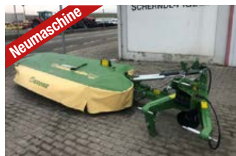
Krone AMR 320 (322 cm) Bj 2022 Heck-Scheibenmäherwerk, 6 Scheiben, 2 Mährommeln, 100° Transportklappung, Safe Cut, ca. 650 kg, ... Preis auf Anfrage
