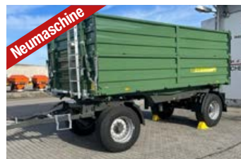
Fuhrmann Kipper (20 m³) Bj 2023 Zwei-Seiten-Kipper, hydr. Bordwandverriegelung, Pendelwände, DL-Bremse, 13.590 kg Nutzlast, 18 t zul. Gew. Preis auf Anfrage
