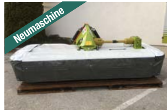
Claas Disco 3150F (300 cm) Bj 2022 Front-Scheibenmäherwerk, MAX CUT Balken mit 7 Scheiben je 2 Messer, SAFETY LINK Sicherheitsmodul, Federentl., ... Preis inkl. 20 % MWST. EUR 14.900,-
