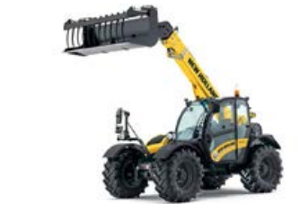
New Holland TH9.35 Stage V (145 PS) Bj 2022 5 h, 900 cm Hubhöhe, 3.500 kg Hubkraft, 4-Rad-Lenkung, Hydrostat, Manitou Gabelträger, Powershuttle, ... Preis exkl. 20 % MWSt. EUR 99.000,-
