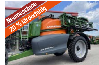
Amazona UX 5201 Super (30 m) Bj 2022 Symbolfoto, Lenkachse 28°, hydr. Klappbar, 2100 mm Spur, nachlaufreinr., hydr. Stützfuß, 520 l/min Pumpe, ... Preis auf Anfrage
