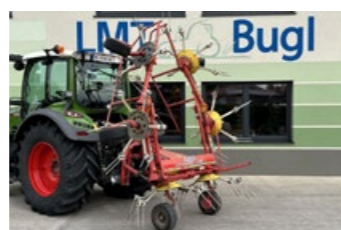
Pöttinger Euro Hit 69NZ (645 cm) Bj 2004 Anbau-Kreiselhauer, 6 Kreisel je 6 Arme, hydr. Grenzstreueinr., hydr. Aushebung, ca. 50 PS, ca. 725 kg, ... Preis inkl. MWST./Verm. EUR 6.250,-
