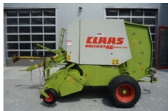
Claas Rollant 46 Roto Cut Bj 1996 Festkammer-Ballenpresse, 16 Messer Schneidwerk, Zentralschmierung, ohne Bremse, Netzbindung, RNH, ... Preis inkl. MWSt./Verm. EUR 11.900,-
