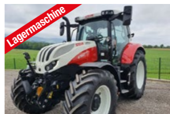
Steyr 6150 Profi S-Control 8 (150 PS) Bj 2023 Allrad, 50 km/h, FH, FZW, Luftsitz, Klima, ISOBUS, 4-Rad Bremse, hydr. DL, gefed. VA, gefed. Kab, DW 4 Preis inkl. 20 % MWSt. EUR 129.900,-
