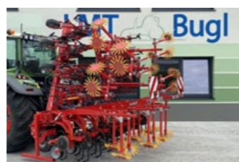
Einböck Chopstar ERS + Row Guard 500 Bj 2020 12-reihiges Hackgerät (45 cm), Kameralenkung, 500 mm Verschieberahmen, Oberlenkersensor, Einzelaushebung Preis inkl. 20 % MWST. EUR 69.000,-
