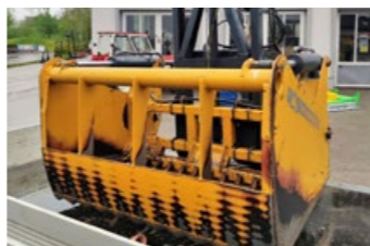
Mammut SC 170 M (170 cm) Bj 2011 Siloblocksneider, Heckanbau mit Hubgerüst 2,5 m, verstärkte Zinken, 1,05 m³, nur 1xEW + freier RL benötigt Preis inkl. MWSt./Verm. EUR 4.900,-
