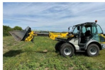
Kramer Allrad 8085T (75 PS) Bj 2015 4.500 mm Hubhöhe, 3 Lenkart, Hydrostat, 40 km/h, typisiert, Schnellwechsellrahmen, hydr. Geräteverr., ... Preis inkl. 20 % MWSt. EUR 65.900
