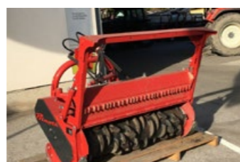
Prineth M450m-1450 (145 cm) Bj 2020 20 h, Gestrüppmulcher, mech. Antrieb, ab 75 PS, Kettenvorhang, 165 cm Gesamtbreite, hydr. Klappe, 450 kg, ... Preis auf Anfrage
