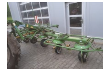
Krone KW 6.02-06 (600 cm) Bj 2010 Kreisler, 6 Kreisler mit je 5 Zinkenarmen, Gelenkwelle, Streuwinkelverstellung, Dreipunkt Anbaubock, ... Preis inkl. MWSt./Verm. EUR 5.100,-
