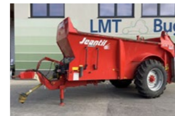
Jeantil EVR12 (12 m³) Bj 2021 Einachser, DL-Bremse mit ALB, hydr. Vorschub, Stützfuß, hydr. Stauschieber, 2 stehende Streuwalzen, ... Preis inkl. 20 % MWST. EUR 27.600,-
